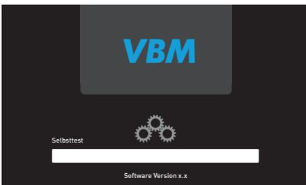
Das Gerät führt beim Einschalten automatisch einen Selbsttest durch. Dieser dauert ca. 30 Sekunden.
